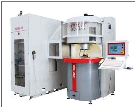
Äußerst kompakte Elektrodenfabrik: HSC 200 und AWEX 99 ERC für alle gängigen Paletten. Foto: exeron
