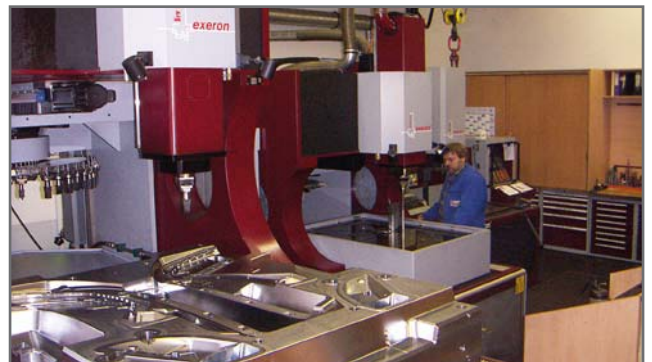
Aufgeräumt: Die Erodierbearbeitung arbeitet bei Schweiger zentral mit mehreren exeron-Bearbeitungszentren. Foto: exeron
