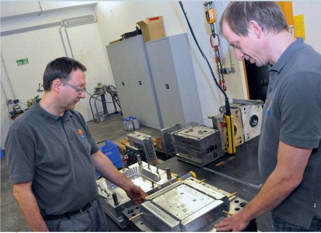
**Aluminiumwerkzeug:** Aufgrund der kleinen Seriengröße entschied sich das Team von Canto (links Guido Wirth, rechts im Bild Hendrik Schulte) für den gut zu bearbeitenden Werkstoff Aluminium.
